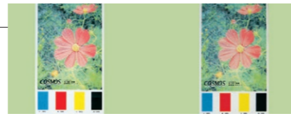
↑試験前 (0時間) ↑試験後 (5,500時間) ※サンシャイン型ウエザオメーター試験結果 5,500時間経過後も“遜色なし”
